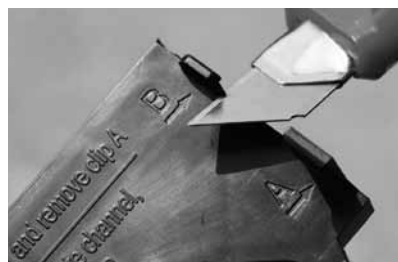
X-deel links en rechts met een mesje afsnijden. Clip B links en rechts met een mesje afsnijden.
