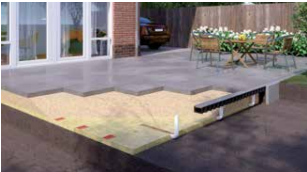
03. Infiltratie van regenwater direct onder het terras.
